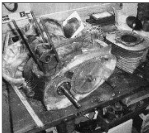
Vaikeimman kautta: mäntä oli hajotettava, että sylinteri saatiin irti.
