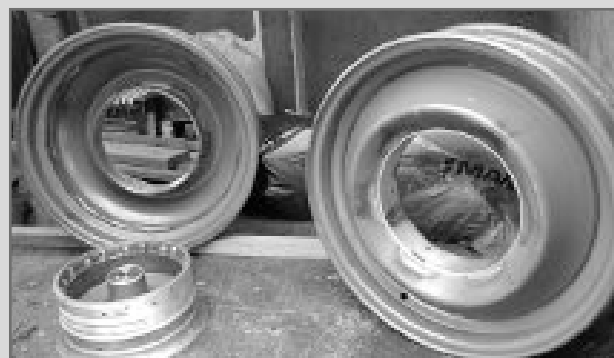
Kuva 2. ETZ:n takanapa sorvattuna ja 2CV:n vanne työstettynä. Vanteen peltisaumoja vahvistettiin hitsaamalla varmuuden vuoksi. Kuvassa erottuu myös mankeloitu lattarauta ja top-ruuvien reiät.
